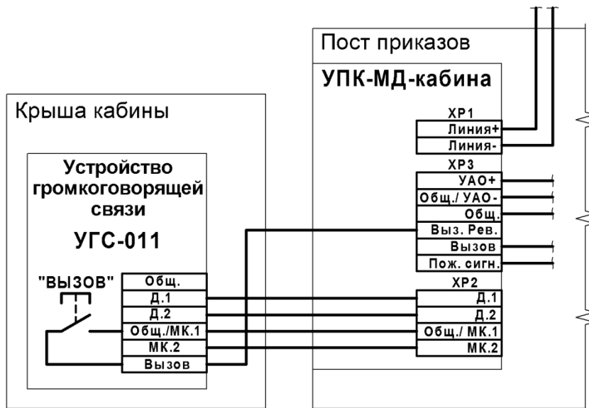
Рисунок 1.7 - Схема подключения устройства громкоговорящей связи УГС-011 НШЕК.465112.011 к устройству переговорному УП(К)-МД-кабина НШЕК.465112.005. Остальное см. рис.1.1, 1.3
