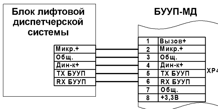
Рисунок 2.1 – Схема подключения к блоку БЛ(К), БЛ(К)-У \ БЛ(К)-У (без встроенного УП) диспетчерского комплекса «Купол»
